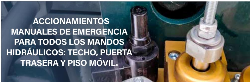
**ACCIONAMIENTOS MANUALES DE EMERGENCIA PARA TODOS LOS MANDOS HIDRÁULICOS: TECHO, PUERTA TRASERA Y PISO MÓVIL.**
