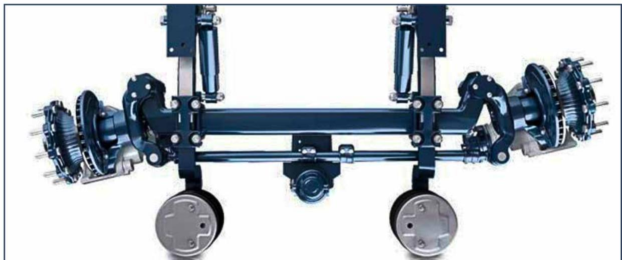
**MONTAJE DE 3ER EJE AUTODIRECCIONAL BPW CON QUIEBRO**
