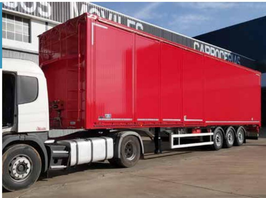
El modelo LD Front dispone de un chasis continuo con un cuello de 80 mm de altura reforzado para poder operar con garantías 1 juego de puertas laterales en la parte delantera. Carga máxima en el pivote de acoplamiento (KP) de 12 tn. Altura de paso libre en los laterales de 2.530 mm con una altura KP de 1.120 mm.
