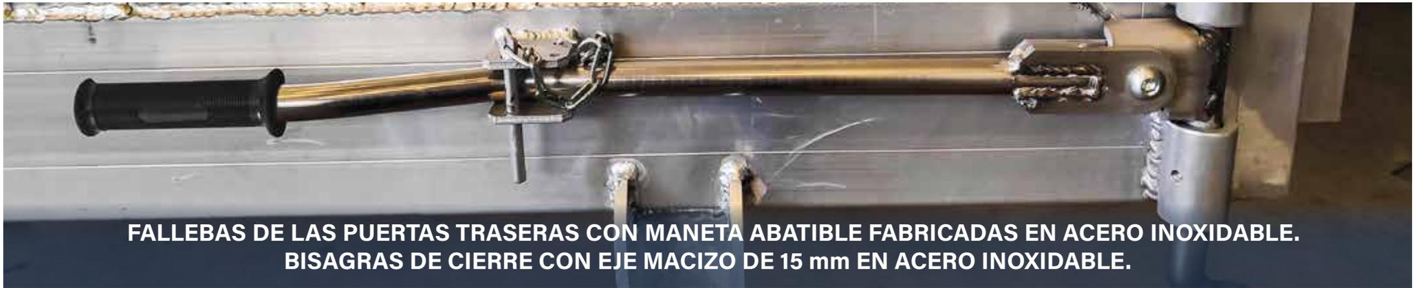
**FALLEBAS DE LAS PUERTAS TRASERAS CON MANETA ABATIBLE FABRICADAS EN ACERO INOXIDABLE. BISAGRAS DE CIERRE CON EJE MACIZO DE 15 mm EN ACERO INOXIDABLE.**
