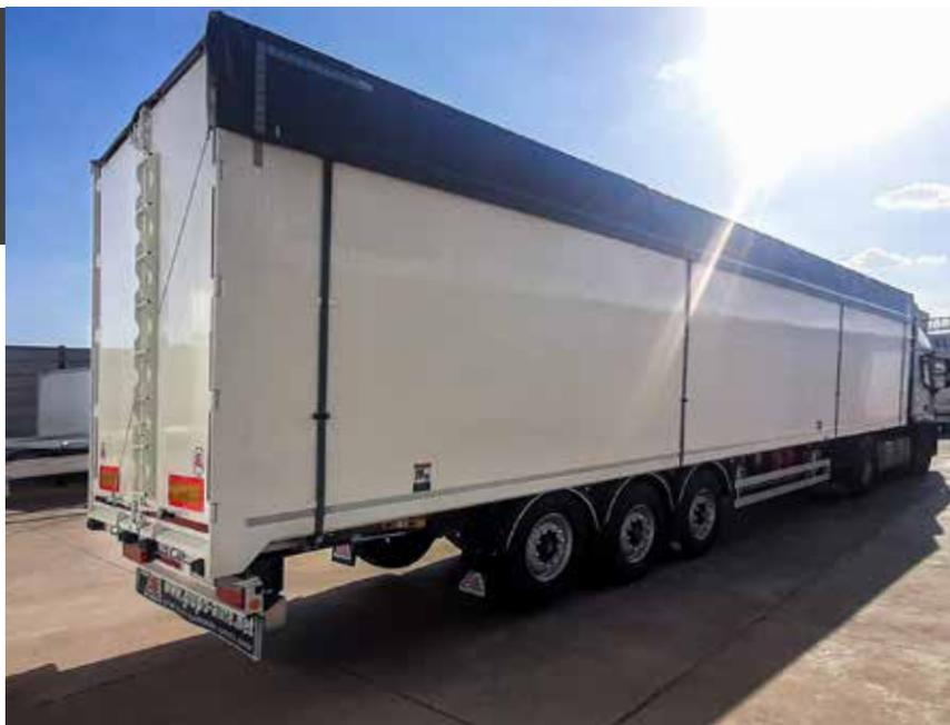
Les modèles de la famille Conical Half sont équipés de la roue 385/65 R22.5 et vous offrent le volume de chargement le plus élevé possible grâce à leur châssis abaissé et conicité maximale de leur carrosserie.
