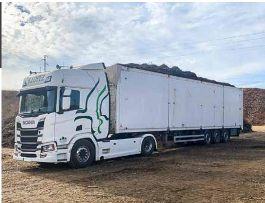
Les modèles de la famille Conical Full sont équipés de la roue 385/55 R22.5 et offrent le volume de chargement le plus élevé possible grâce à leur châssis abaissé et conicité maximale de leur carrosserie.
