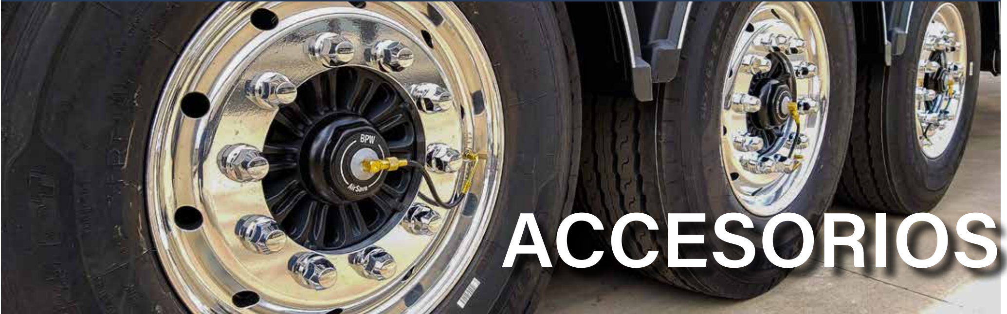
SISTEMA DE AUTOINFLADO BPW AIRSAVE
