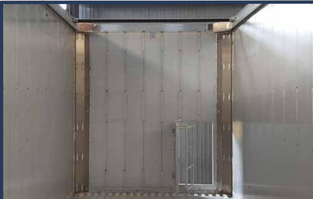
CHANGEMENT DE LA LONGUEUR INTÉRIEURE UTILE DE 13.500 À 13.620 mm AVEC CHANFREIN INTÉRIEUR
