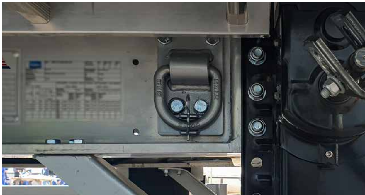
AJOUTER 4 ANNEAUX SUR LE CHÂSSIS POUR ATTACHER LE VEHICLE EMBARQUÉ
