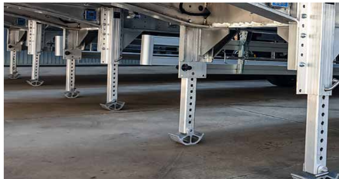
BÉQUILLE EN ALUMINIUM AVEC EXTENSION MANUELLE
