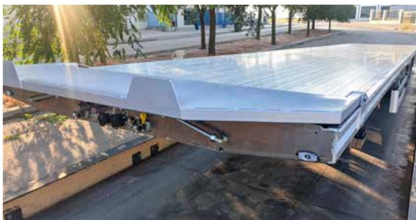
Construction intégrale en aluminium de type plateau fond mouvant dedimensions 13,600 x 2,550 mm avec une base rabattable avant de 300mm.
