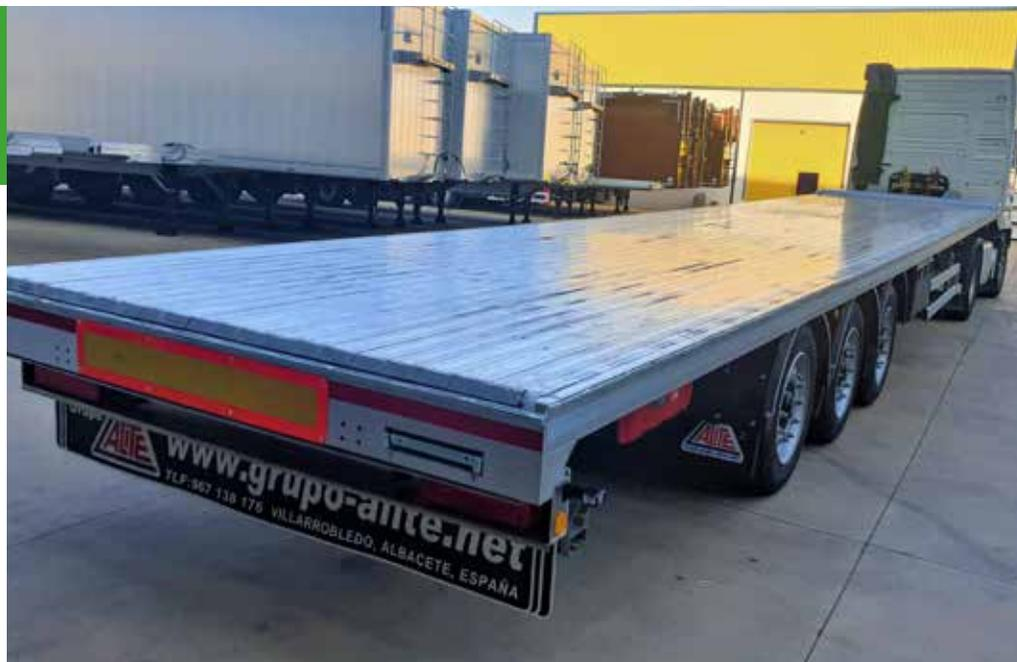
Le modèle OPEN NAKED dispose d'un châssis continu avec un col de cygne de 120 mm de hauteur pour une hauteur de cinquième roue de votre tracteur de 1000 à 1050 mm. Charge maximale sur le pivot de couplage (KP) de 12 tn.
