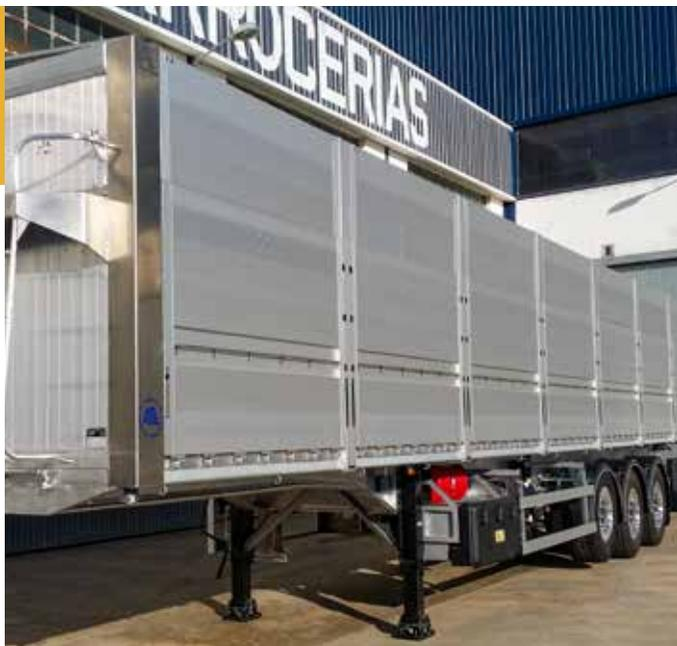
Le modèle OPEN Clear dispose d'un châssis continu avec un col de cygne de 150 mm de hauteur pour une hauteur de sellette d'attelage de votre tracteur de 1150 à 1200 mm. Charge maximale sur le pivot d'accouplement (KP) de 12 tn.
