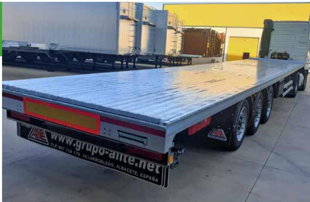
El modelo OPEN NAKED dispone de un chasis continuo con un cuello de 1200 mm de altura para una altura de quinta rueda de tu cabeza tractora de 1.000 a 1.050 mm. Carga máxima en el pivote de acoplamiento (KP) de 12 tn.
