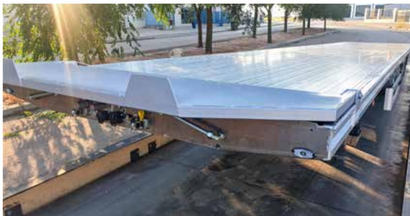
Construcción integral de aluminio tipo plataforma piso móvil de dimensiones 13.600 x 2.550 mm con una base abatible delantera de 300 mm.
