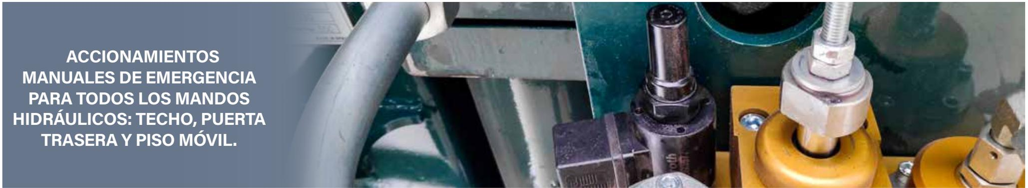
**ACCIONAMIENTOS MANUALES DE EMERGENCIA PARA TODOS LOS MANDOS HIDRÁULICOS: TECHO, PUERTA TRASERA Y PISO MÓVIL.**
