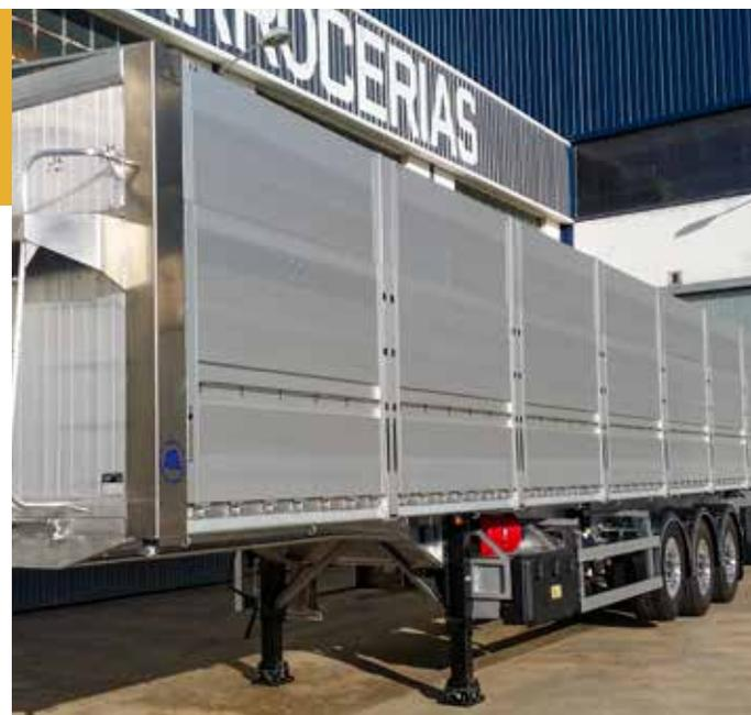
El modelo OPEN Clear dispone de un chasis continuo con un cuello de 150 mm de altura para una altura de quinta rueda de tu cabeza tractora de 1.150 a 1.200 mm. Carga máxima en el pivote de acoplamiento (KP) de 12 tn.
