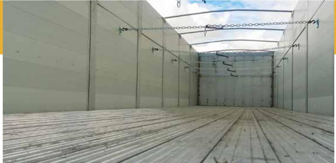
Construcción de caja abierta tipo laterales abatibles con suplementos. Monta en cada lado seis (6) laterales de 1.300 mm de altura y seis (6) suplementos de 600 mm desmontables de aluminio anodizado. Diez (10) pilares de aluminio fijos con tres (3) uñas de cierre para las puertas laterales. Techo estándar tipo lona colgada sobre cables de acero .
