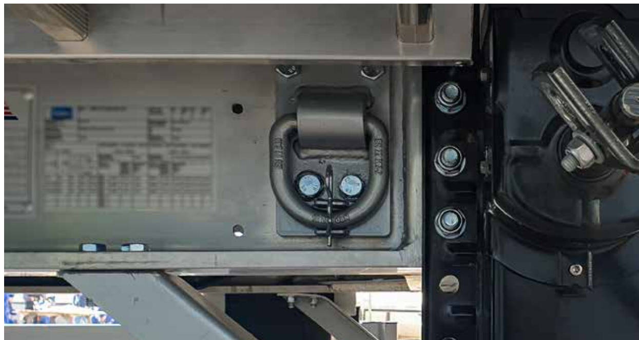
AÑADIR 4 ARGOLLAS EN CHASIS PARA AMARRE DE VEHÍCULO EMBARCADO
