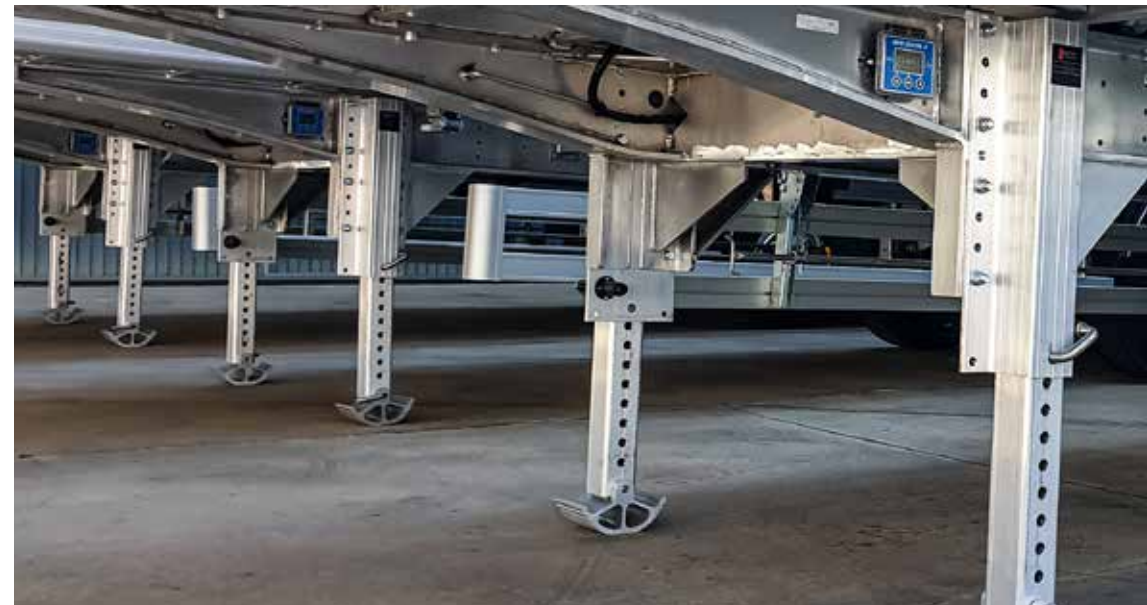
PATAS DE ALUMINIO CON EXTENSIÓN MANUAL
