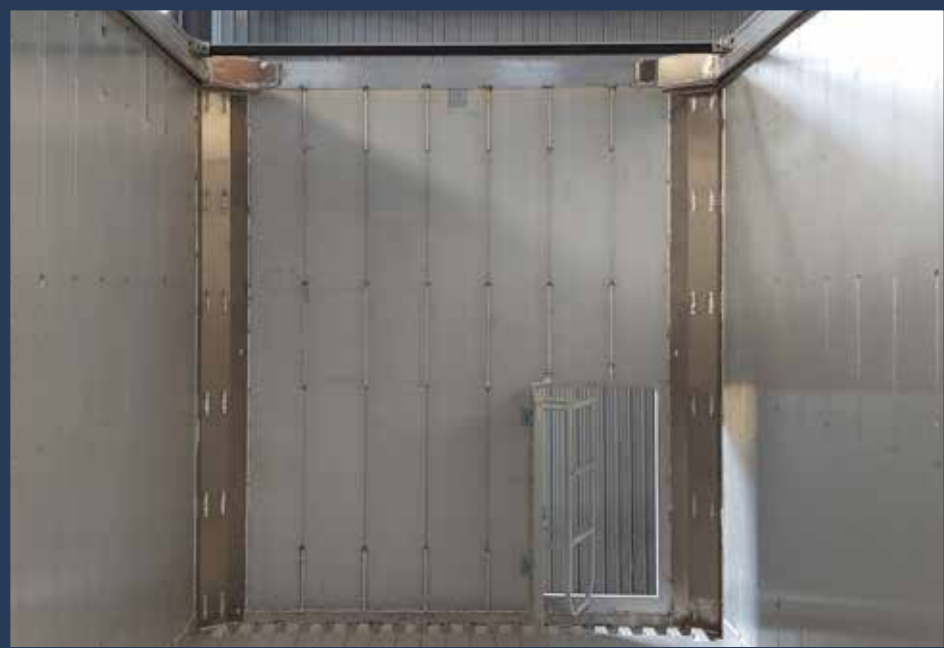
CAMBIO DE LONGITUD INTERIOR ÚTIL DE 13.500 A 13.620 mm CON CHAFLÁN INTERIOR
