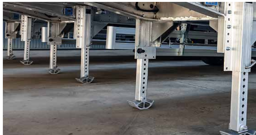
BÉQUILLE EN ALUMINIUM AVEC EXTENSION MANUELLE
