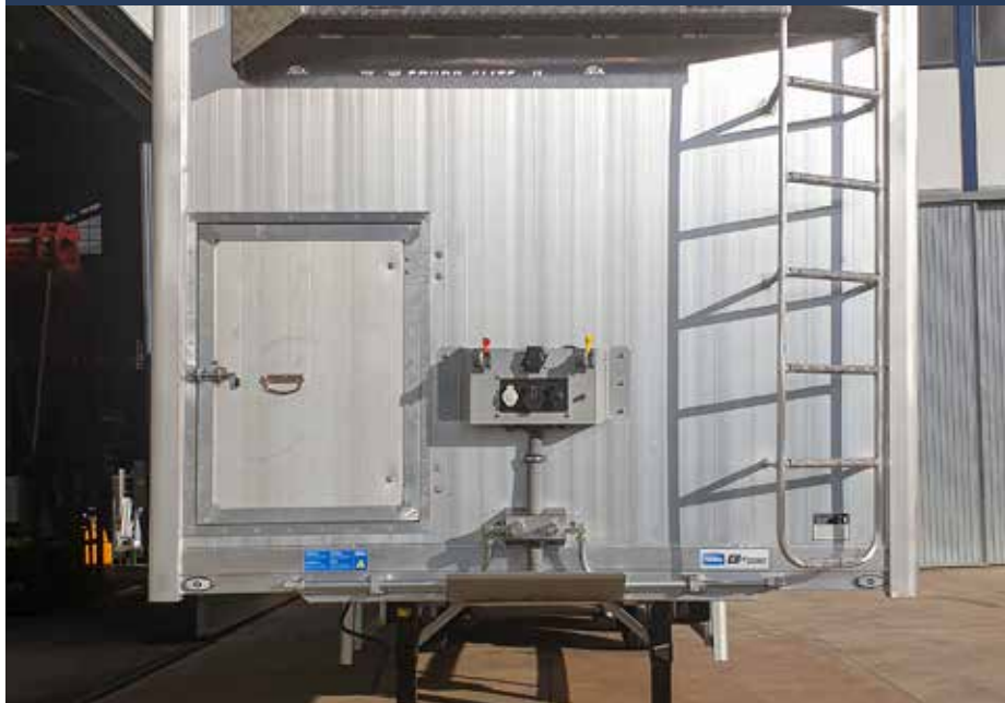
PORTE D'ACCÈS AVANT
