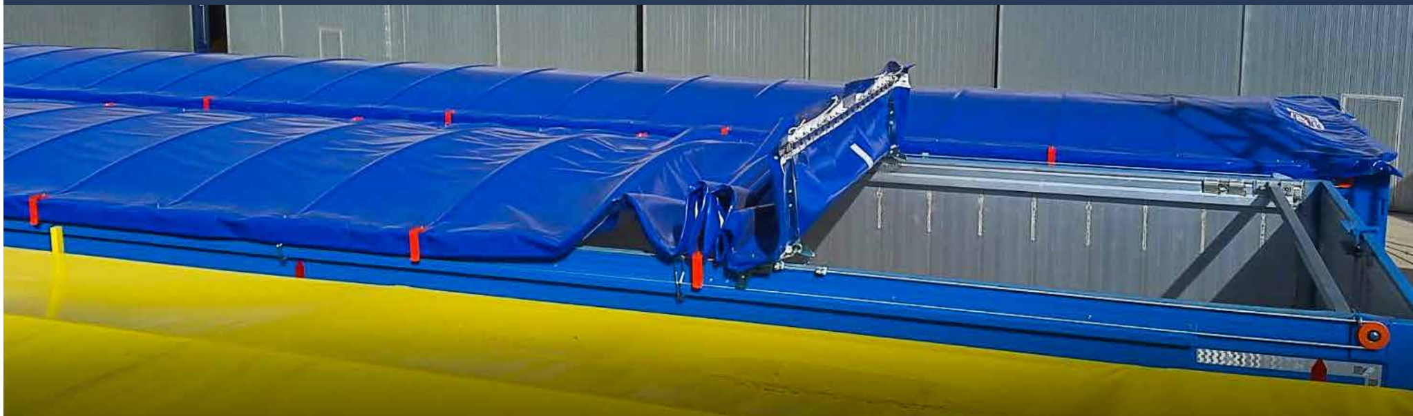
TOIT COULISSANT AUTOMATIQUE ÉLECTRIQUE
