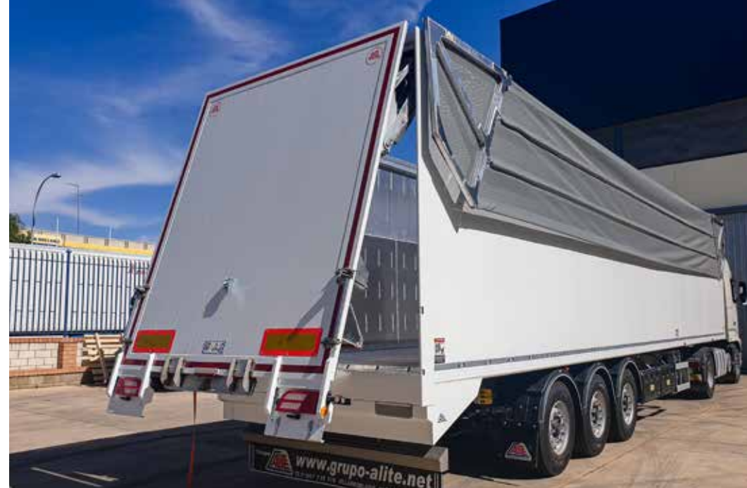
PORTE ARRIÈRE HERMÉTIQUE AVEC ACTIONNEMENT HYDRAULIQUES ET FERMETURES SYNCHRONISÉS
