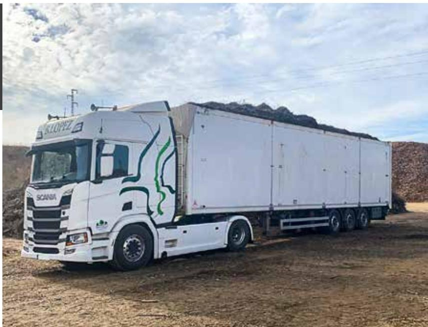
Los modelos de la familia Conical Full montan la rueda 385/55 R22,5 y te ofrecen el mayor volumen de carga posible gracias a su chasis rebajado y la conicidad máxima de su carrozado.
