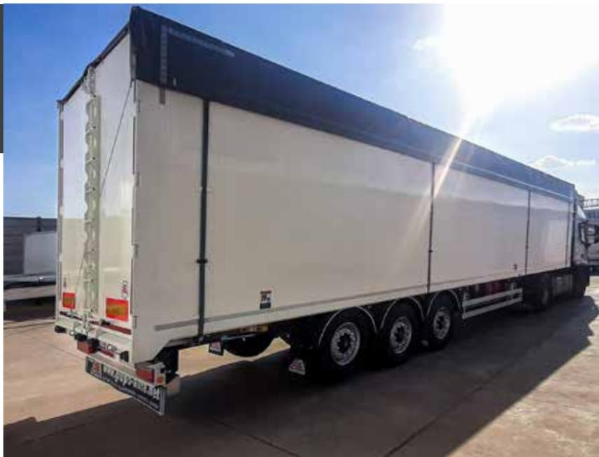
Los modelos de la familia Conical Half montan la rueda 385/65 R22,5 y te ofrecen el mayor volumen de carga posible gracias a su chasis rebajado y la conicidad máxima de su carrozado.
