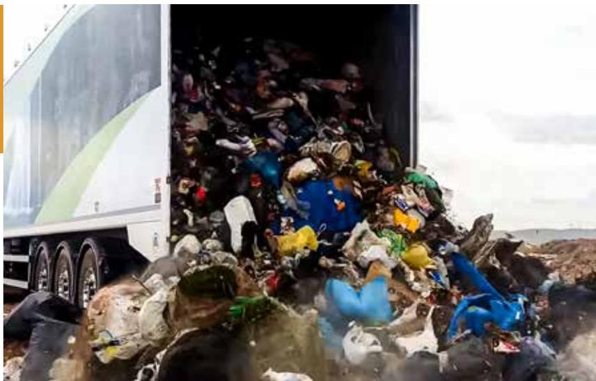
El vehículo WetLoad está pensado para transportar mercancías con baja carga de componente fluida, garantizando vertidos mínimos a un precio ajustado. Los modelos de la familia WetLoad disponen de un depósito trasero para la recogida parcial de fluidos. Existe la posibilidad de configurar el vehículo para el transporte de residuos sólidos urbanos.
