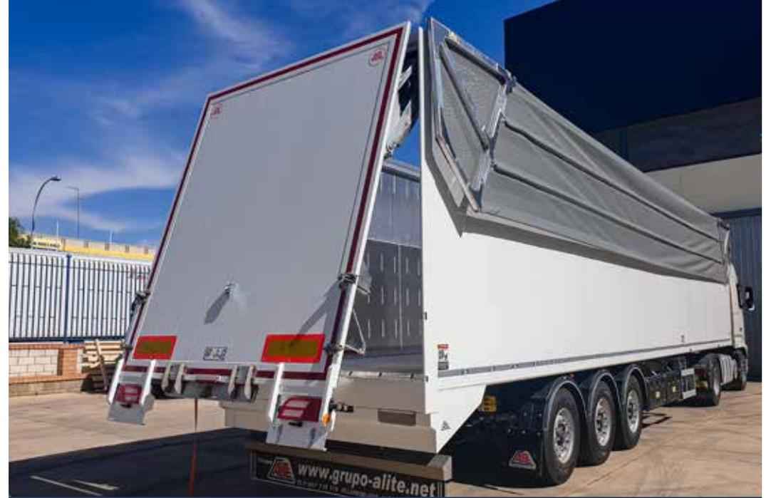
**PUERTA TRASERA HERMÉTICA CON ACCIONAMIENTO HIDRÁULICO Y CIERRES SINCRONIZADOS**
