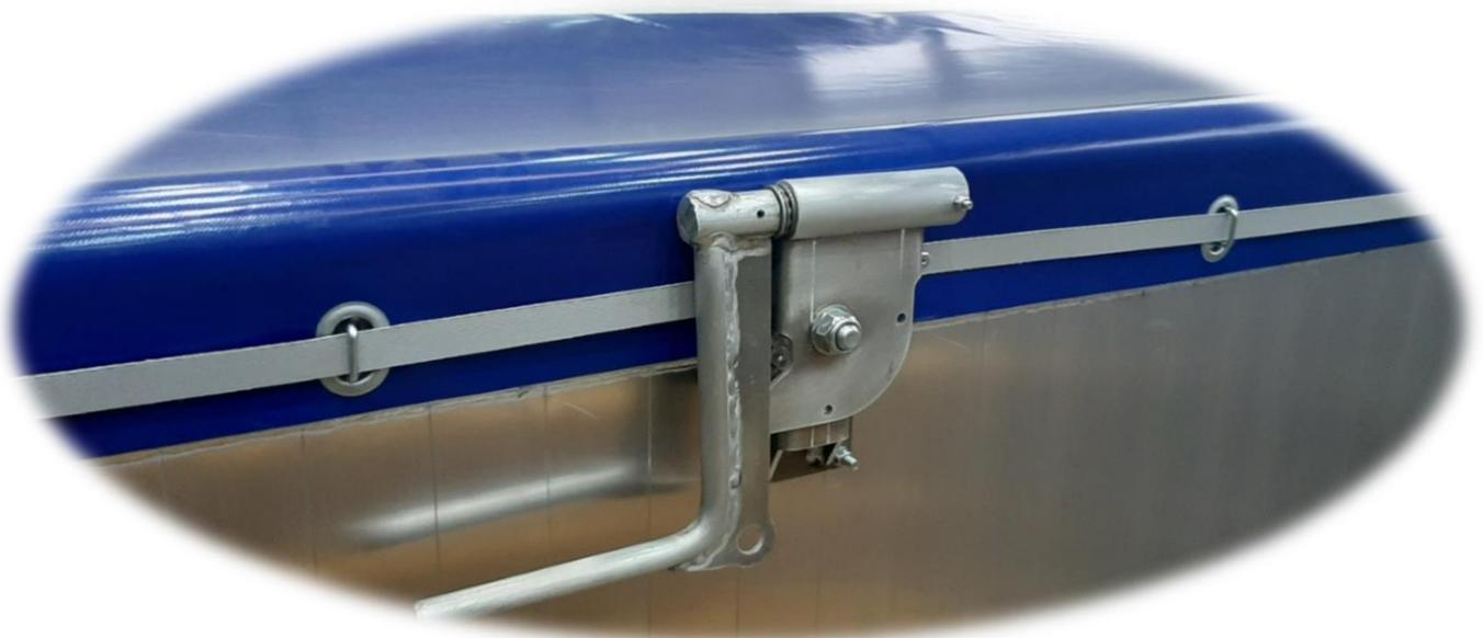
**DETAIL DE LA BAÏONNETTE RABATTUE EN ORDRE DE MARCHÉ AVEC VÉROUILLAGE PAR POSITIONNEUR DE BOULE MECANIQUE.**
