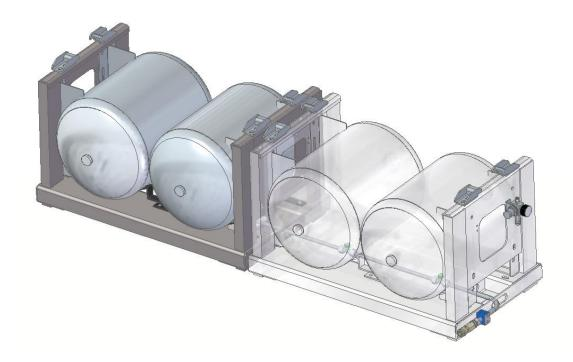
Posibilidad de aumentar la capacidad del dispositivo mediante la incorporación de un módulo de extensión de 120 l de capacidad adicional (total 240 l). Montaje modular en paralelo o en serie con el módulo principal. Conexión entre módulos con tubo flexible de poliamida PA11 de 14x1,5 mm.
