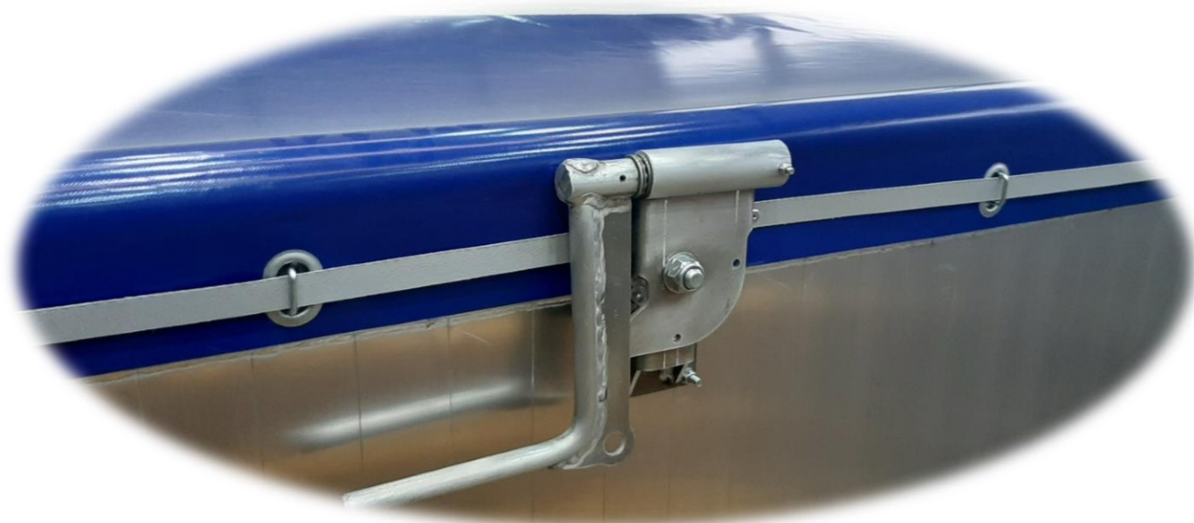
DETALLE DE LA BAYONETA ABATIDA EN ORDEN DE MARCHA CON ENCLAVAMIENTO POR POSICIONADOR DE BOLA MECÁNICO.
